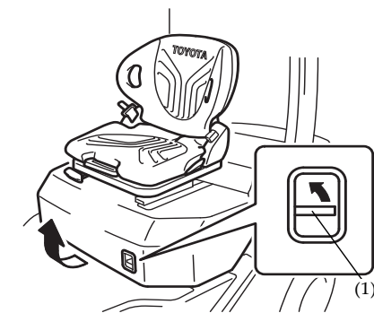
(1) Levier de déverrouillage du capot moteur
